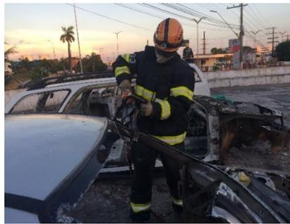
Fig. 11 corte de colunas
