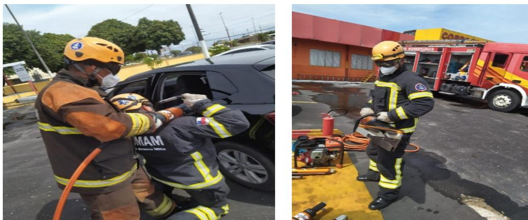
Fig. 22 posições adequadas para operação da ferramenta
