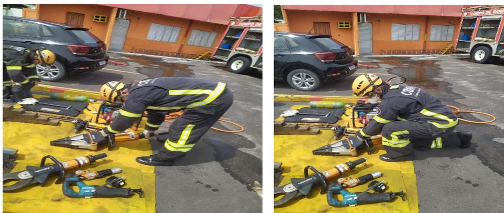
Fig. 21 posição para levantamento da ferramenta Incorreto x correto
